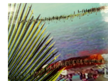
Fig. 6 Tracce di attrito della testina di stampa
