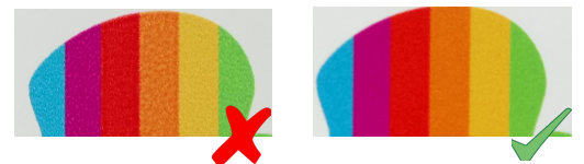
Abb. 9 Einfluss der Temperatur auf die Trocknung im Drucker
