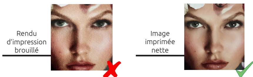
fig 17 Différence d'impression entre une bidirection ajustée et incorrecte
