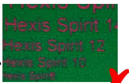
fig 3 Rendus d'impression obtenus pour une hauteur des têtes adaptée et inadaptée par rapport au média
