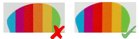
fig 9 Impact de la température sur le séchage de l'imprimante
