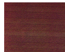
fig 8 banding irrégulier dans un aplat bordeaux
